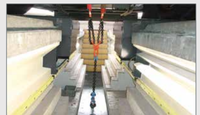
Bodenanker Zum Festhalten des Fahrzeugrahmens bzw. der Achse bei gleichzeitigem Anheben.
