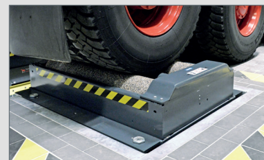
Roller set lifting Hydraulische Rollensatzanhebung zur Verlagerung der Achslast auf die zu prüfende Achse.
