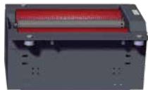
Digitaler Rollen-Bremsprüfstand C_MBT S 15.0 R100 MU mit geteiltem Rollensatz, bis zu 15,0 t Achslast und einer Rollenlänge von 1000 mm, mit Motorposition unterhalb des Rollensatzes.
