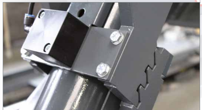
Die Rastenzahnung wird bei Hebebühnen für die Fahrwerksvermessung (Option „Absetzvorrichtung“) durch Fräsen gefertigt und sichert dadurch eine hohe Präzision auf unterschiedliche Arbeitshöhen.
