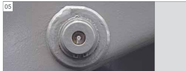
Scherenhauptlager mit Teflon-Gleitlagerbuchse und Schmiernippel, hohe Lebensdauer und Notlauf Eigenschaften.
