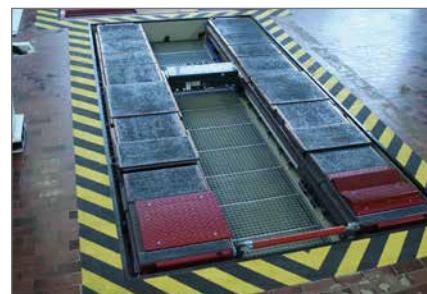
DUO CM im Rechteckfundament mit (optionaler) Gitterberostung (Ausstattung für Fahrzeugprüfung).
