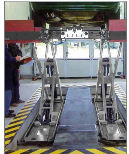
Auch bei Mittelplattform besteht eine nutzbare Hubhöhe von 1850 mm.
