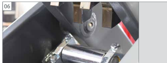
Die Zylinder-Aushubunterstützung mit Stufenhebel und Rollen führt eine reine Abrollbewegung aus. Keine Gleitbewegung zwischen den bewegten Teilen, dadurch geräuselos, verschleiß- und wartungsarm.
