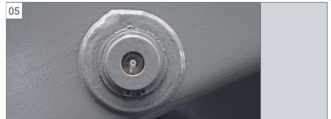
Scherhauptlager mit Teflon-Gleitlagerbuchse und Schmiernippel, hohe Lebensdauer und Notlaufeigen- schaften.
