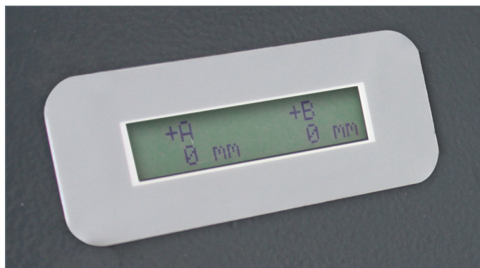
Option „Absetzvorrückung“: LCD am Bedienpult für Anzeige der Niveauewerte.
