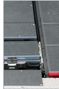
DUO CM im Streifenfundament (Ausstattung für Fahrwerksvermessung).
