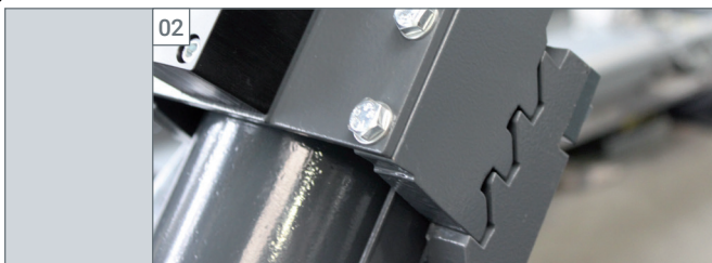
Die pneumatisch aktivierte Klinke dient der Sicherung gegen Absenken bei hydraulischer Leckage.
