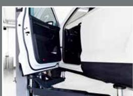
Großer Türöffnungswinkel für leichtes Aussteigen aus dem Fahrzeug durch um 45° gedrehte Säulen (MA STAR 3.5 A).
