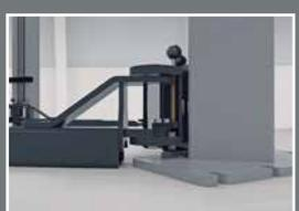
Tragarme schwenken direkt über dem Fußboden, wodurch eine sehr geringe Unter-/Durchschwenkhöhe erreicht wird.
