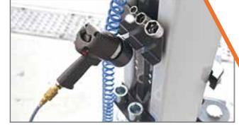
Schlagschrauberhalterung mit integrierter Ablage für Aufnahmeerhöhungen.
