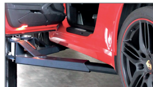
Sportwagentragarme Unterschwenkhöhe 80 mm (MA STAR 3.5 A Comfort)
