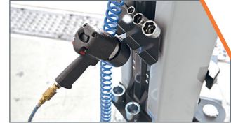
Schlagschrauberhalterung mit integrierter Ablage für Aufnahmeerhöhungen.
